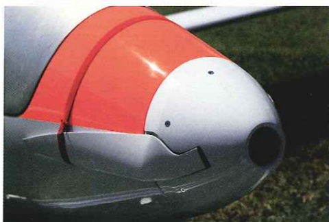
▲ Les pales de l'hélice se replient, une fois qu'elle est bloquée à l'horizontale, le long du nez du fuselage.
