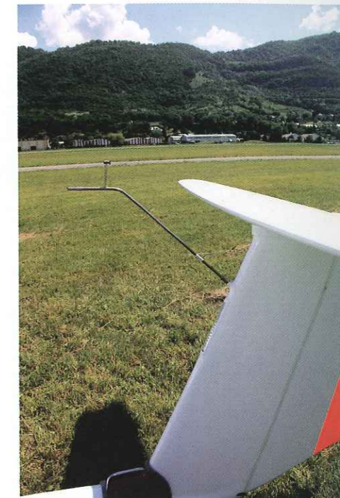
▲ L'antenne de compensation munie d'une prise de pression dynamique et la rangée de LEDs sur le bord d'attaque de la dérive.
